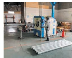
配管フレア加工
