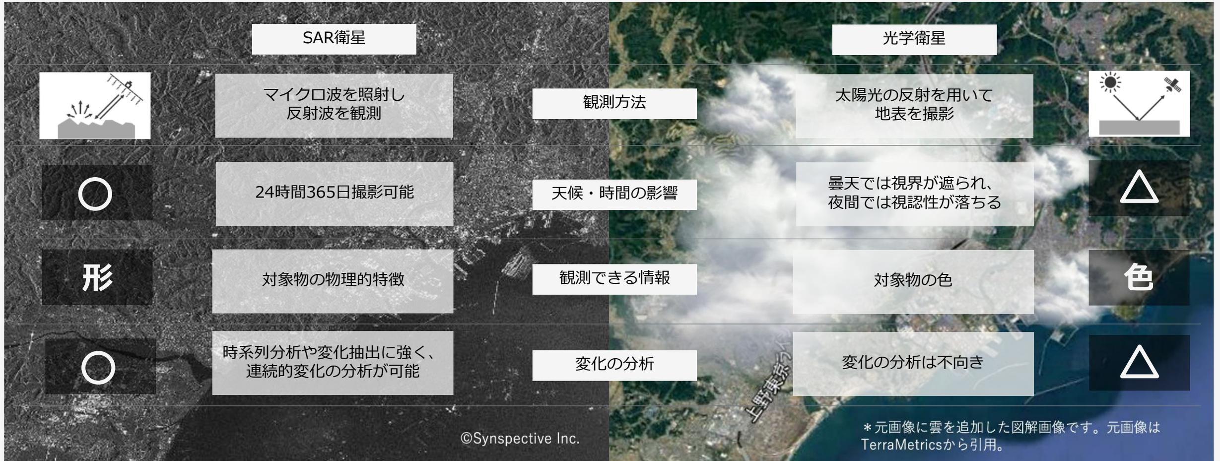
コンステレーション形成のため必要となる小型化・低コスト化を実現したSAR衛星の開発・製造能力と、得られたSAR衛星データから顧客に有意な情報を届けるための解析力が強み
